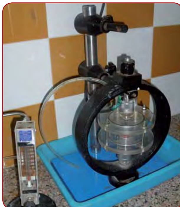
شکل (۱) تصویری از دستگاه تست Tensile جهت اعمال تنش کششی روی نمونه تست SSCC
