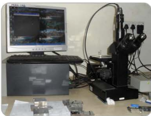
تصویر میکروسکوپ جهت مشاهده و ثبت نتایج HIC
